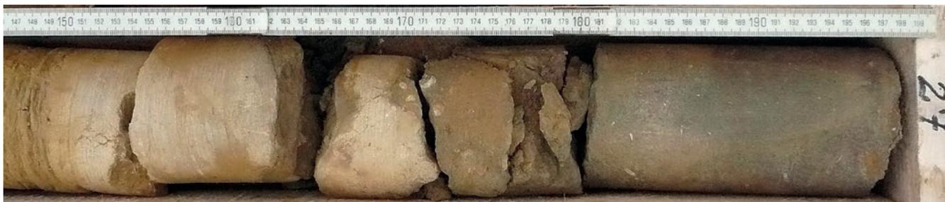
Bild 6: Bohrkern aus der Bohrung Dachselen (27.00 m bis 27.55 m). Erläuterungen im Text.
